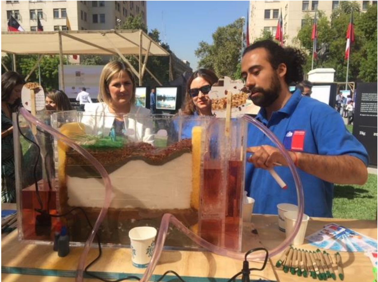
Figura 3. Maqueta explicativa del flujo de agua subterránea.
